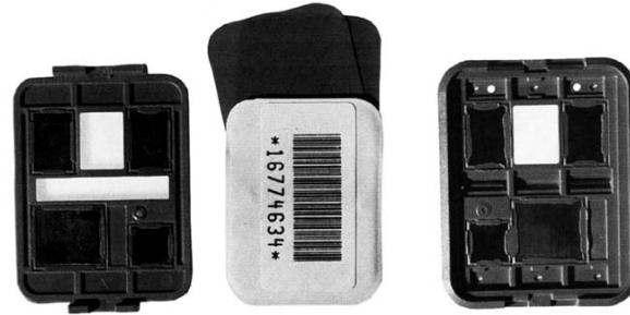
Abb. 8.15: d) Film dosimeter (Kassette aufgeklappt, Dosimeßfilm mit 2 herausgezogenen Negativen) (Physikalisch Technische Werkstätten, aufgenommen bei Staatl. Materialprüfungsamt NRW- Personendosismeßstelle)
